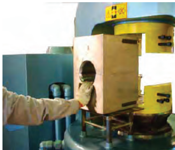
Монтаж матриц в пресс серии «Advanced»
