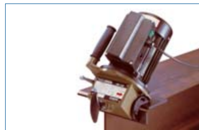
снятие фаски с криволинейных кромок
